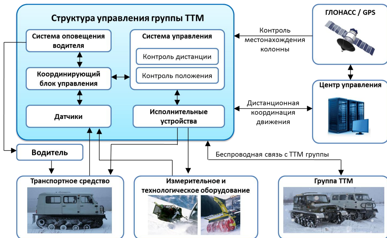
Рис. 4. Структурная схема управления группы ТТМ
