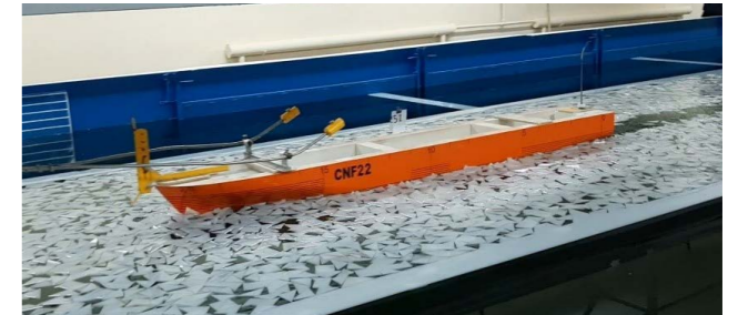
РИС. 8. Фрагменты движения модели судна пр. CNF22 носом во льду сплоченностью 8 баллов и скоростью природы ~12 уз.
