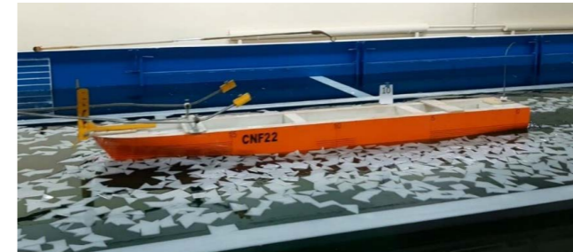
РИС. 7. Фрагменты испытаний при движении модели судна пр. CNF22 носом во льду сплоченностью 4 балла и скоростью природы ~12 уз.
