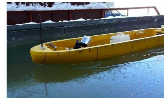
РИС. 15. Движение модели судна пр.00902 в сплошном льду толщиной 4 мм
