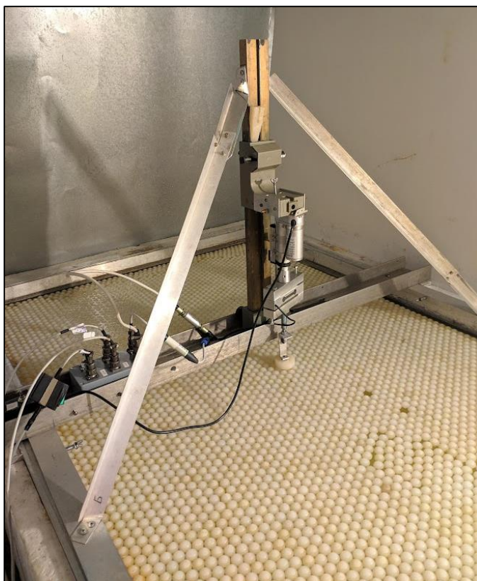
Рисунок 2 - Установка для разрушения ледяного покрова в малом опытном бассейне
