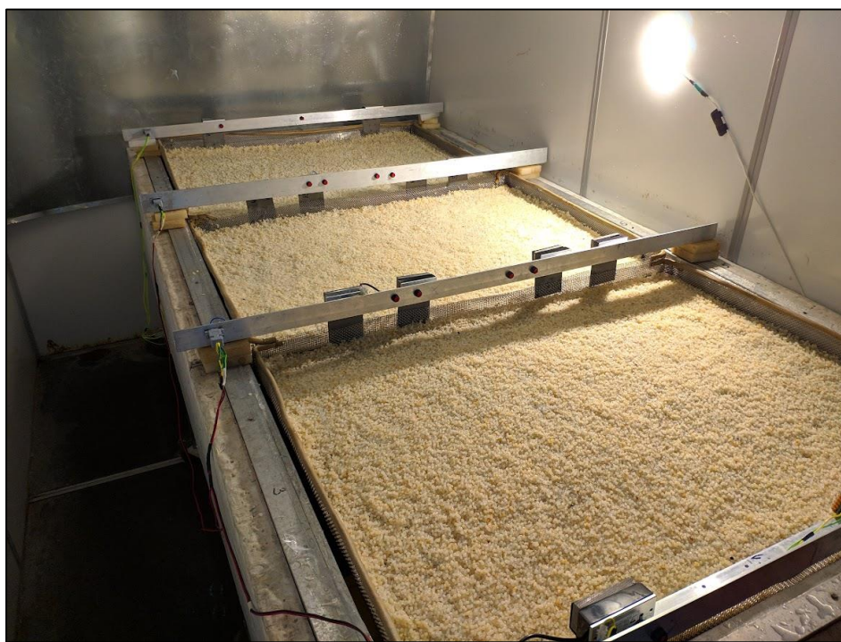
Рисунок 1 - Малый опытовый бассейн с устройством для равномерного укладывания гранул полиэтилена высокого давления
