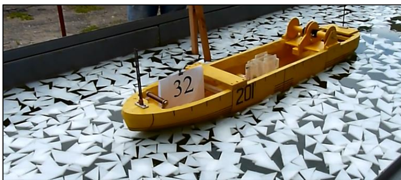
Рисунок 4 - Ледокол в плитках полиэтилена толщиной 20 мм
