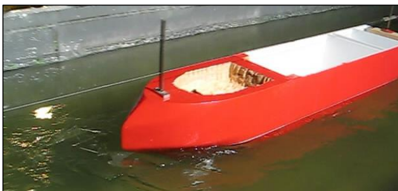
Рисунок 5 - Научно-исследовательское судно в сплошном льду толщиной 3,1 мм
