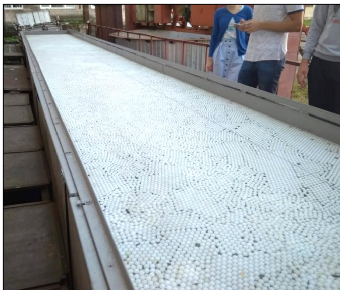
Рисунок 3 - Бассейн с битым (моделированным) льдом в виде гранул полиэтилена
