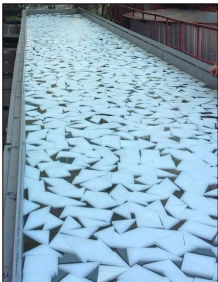
Рисунок 2 - Бассейн с битым (моделированным) льдом в виде треугольных плиток полиэтилена
