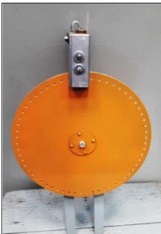
Рисунок 2 - Диск светоимпульсного измерения скорости
